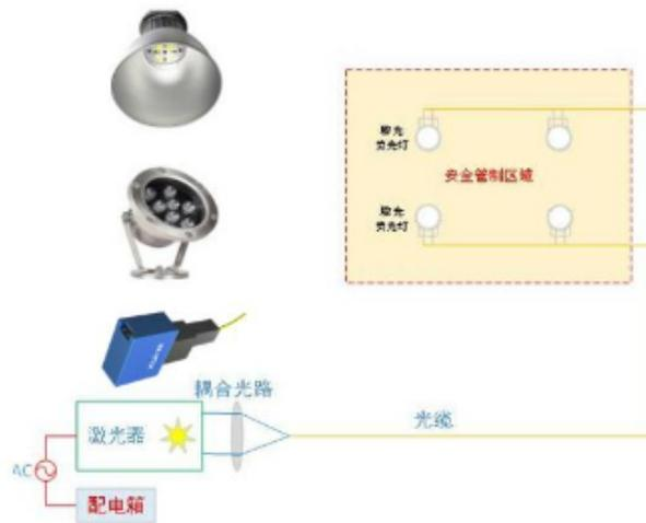
光电分离照明光源系统在水景照明方面有很好的应用，由于光纤有亲水的特性，再加上它光电分离照明光源的特性，所以使用在水景的照明方面，可以轻易营造出设计师想要的效果，而另一方面光电分离照明光源系统也没有电击的问题，能达到安全上的考量。除此之外，应用光纤本身的结构，也可以与水池相互搭配，光电分离照明光源系统让光纤本体也成为水景的一部份，这是其它照明设计不易达成的效果。泳池的光电分离照明光源系统亦或是现在流行的SPA场合的照明，光纤的应用可说是比较好选择。因为这是人体活动的场所，安全性的考量远高于上面的水池或是其它室内场所，因此光纤本身的光电分离特性，加上光电分离照明光源系统无可匹敌的优点，以及色彩的多样演色效果，同时可以满足这一类场所的需求。
